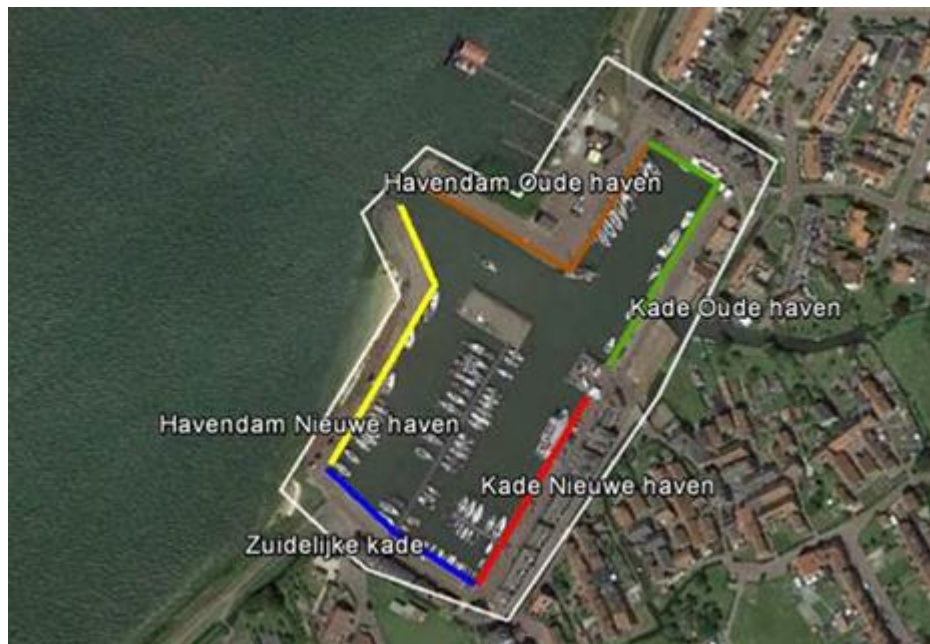
Figuur 3.12 Aan te passen damwanden binnen de haven. De in groen, rood en blauw aangegeven kadedelen worden aangepast. Het bruine deel vormt geen onderdeel van de waterkering en is in goede staat.
