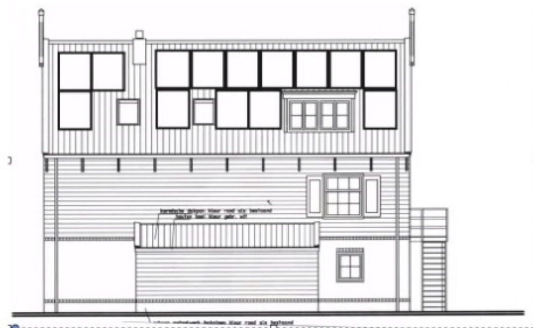
Achtergevel nieuw, zonnepanelen 1134 mm x 1722mm
