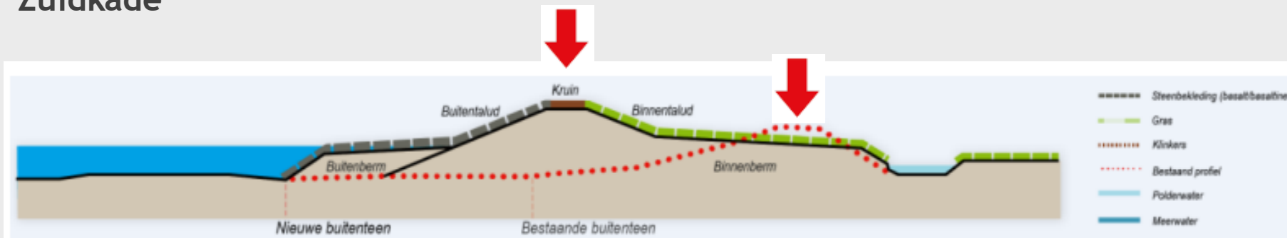
Figuur 2.5 Dwarsprofiel Zuidkade, compact profiel
