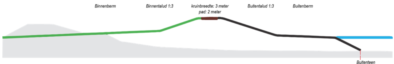
Figuur 3.1 Principeprofiel van de nieuwe kade
