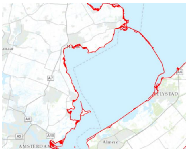
Figuur 4.2 Buitendijkse gebieden Markermeer die lager liggen dan N.A.P. +0,50 m en niet omsloten zijn door een hoge kade of dijk (rood is beschouwd gebied buiten primaire kering en oranje is beschouwd gebied binnen primaire kering (RWS, 2018)). Het hier getoonde aantal gebieden is wat anders dan de genoemde objecten in Tabel 4.1.
