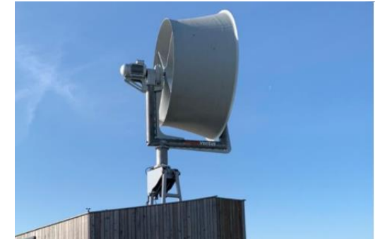
Figuur 2.5: DutchVentus windturbine op daken te plaatsen. Deze heeft een diameter van 3,5 m en een vermogen van 10 kW (0,01MW), opbrengst van 18 MWh/jaar, Bron: nwea.nl
