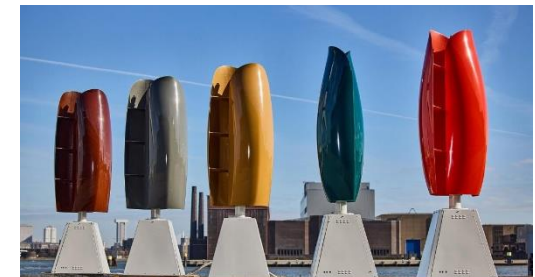
Figuur 2.6: Windturbines met een ludieke vormgeving die draaien om de verticale as
